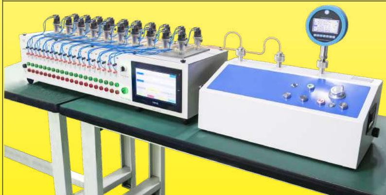
**Überprüfung der Druckschalterkalibrierung**
