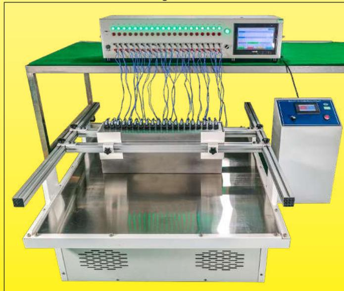
Prüfeinrichtung zur Messung der Vibrationsfestigkeit von Luftschaltern und des Schleichkontakte von Druckschaltern durch Simulation von Transportbedingungen (Ultimheat Labor)
