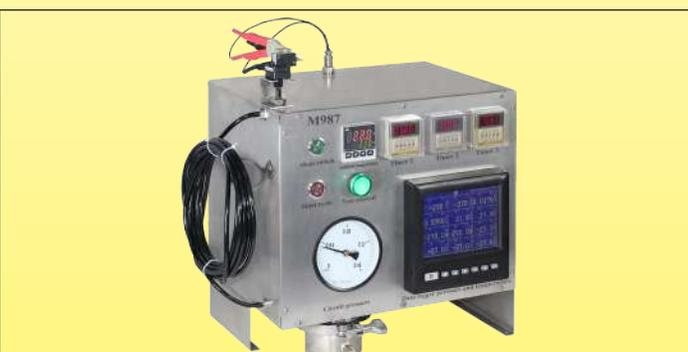
Prüfergerät zur wiederholten und konstanten Messung der maximalen Länge der Verbindungsschläuche des Luftscharter in Abhängigkeit vom Volumen des Drucktaster und dem von ihm entwickelten Druck (Ultimheat Labor)
