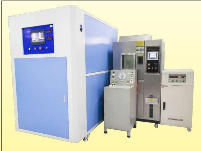
**Elektrische Lebensdauer-Prüfgeräte für Druckschalter**
